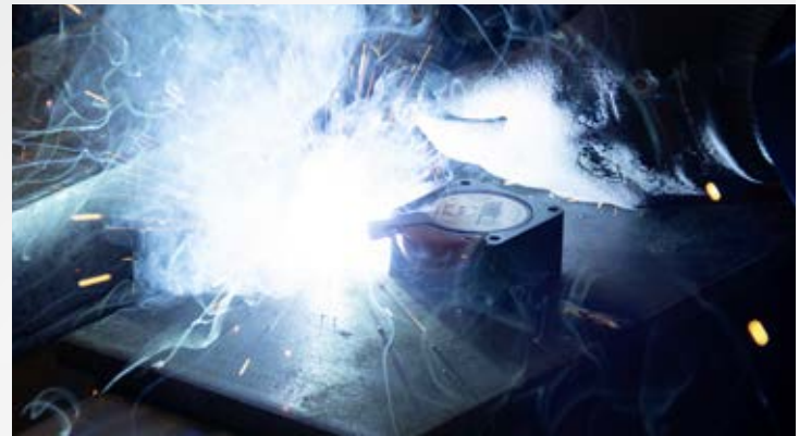
Anstatt umständlichem Klammern: der TMC 70 zum einfachen Fixieren von Metallteilen für Schweiß-Arbeiten
